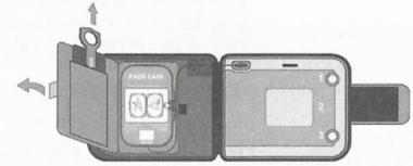
Inserire l'attivatore nello slot in alto al centro del pannello anteriore del defibrillatore FRx. Inserire l'attivatore come mostrato sulla parte posteriore dell'attivatore. La porzione rosa dell'attivatore gira (1) e si inserisce nello slot (2), con la parte anteriore dell'attivatore in posizione orizzontale sulla superficie dell'FRx in modo che risulti visibile lo schema di posizionamento degli elettrodi pediatrici.
